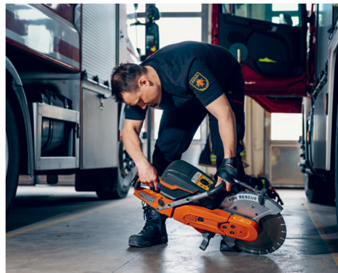
Laikkaleikkurilla saa avattua jyrkempiäkin rakenteita, kuten terästä ja betonia.
